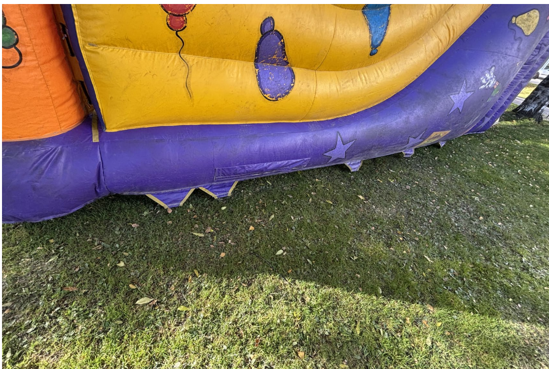
Bild 2. Flera förankringspunkter som inte är fästa i marken. Alla fästpunkter måste vara förankrade så att hoppborgen inte kan välta eller blåsa iväg.
