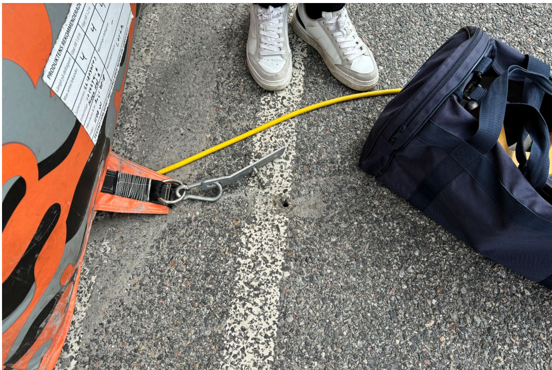
Bild 4. Två markskruv lossnade enkelt ur asfalten när Konsumentverkets personal petade på dem.
