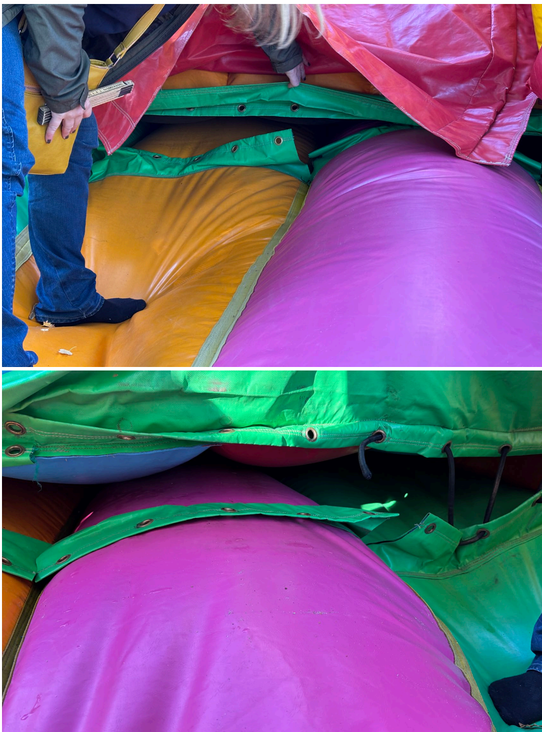
Bild 9 och 10. Öppning där barn kan krypa in och riskera att bli klämda av andra barn som hoppar ovanpå eller kvävda om de blir kvar inne i öppningen.
