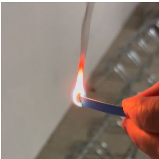
Bild 12. Brandtest av provbit från en av hoppborgarna. När en låga som antänder materialet avlägsnas ska materialet inte brinna vidare. Detta material slutade inte att brinna och var alltså brandfarligt.
