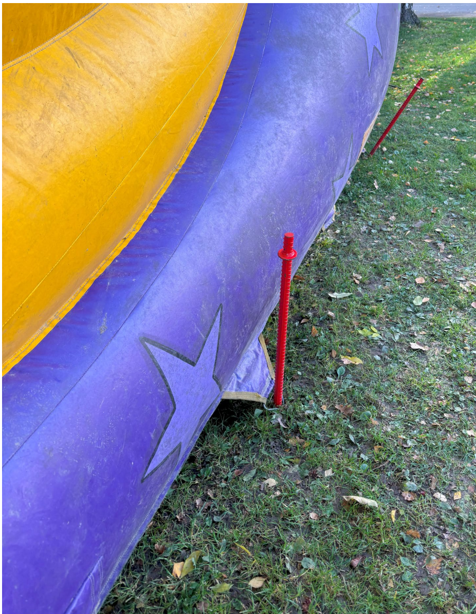
Bild 3. Förankringsspett som sticker upp 65 cm: Förankringsspett får inte sticka upp ur marken mer än 2,5 cm på grund av att de finns i fallutrymmet intill hoppborgen och det finns risk för att någon slår sig mot det.
